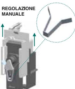
**ATTENZIONE:** Nel caso in cui fosse necessario riportare la Compensazione Telescopica SUPERIORE CON molla a nastro nella posizione di partenza indicata col segno "0", bisogna stringere con le dita l'estremità della molla a nastro e contemporaneamente far traslare i due corpi compensatori (vedi figura a lato).
