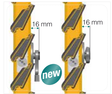
A richiesta sono disponibili sistemi Rotary con maniglia a pomo e maniglia a manovella ribassati
